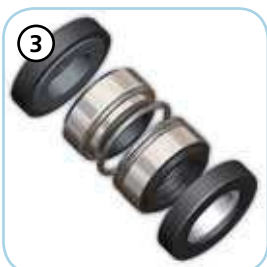
Gleitringdichtungen Dreifaches Dichtungssystem aus; zwei Gleitringdichtungen (SiC-Al) in Ölkammer mit Schmierung mit Speiseöl, V-ring in direktem Kontakt mit der Flüssigkeit.
